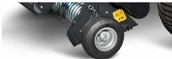
Nagy átmérőjű, könnyen állítható mélységátaroló kerekek.
